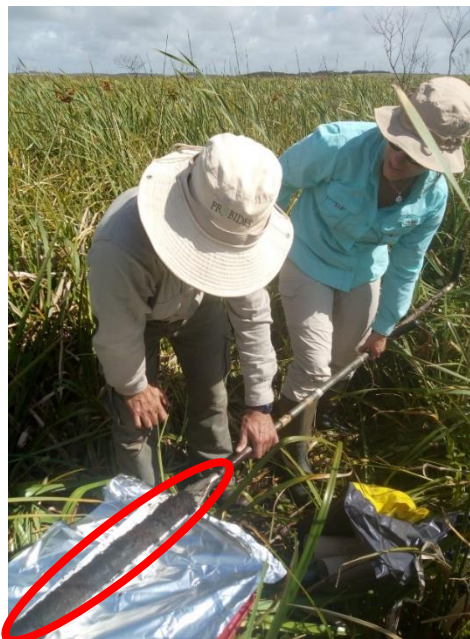
Figura 12. Sonda rusa cargada de turba (óvalo rojo), sobre papel aluminio utilizado para guardar la muestra
